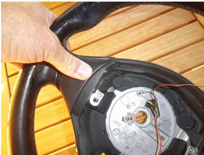
6) Branchement des 2 câbles, remise en place du bloc airbag.
