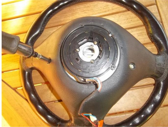
3) Soulever le bloc airbag, le retourner et retrait des 2 câbles (voir flèches), le déposer.
