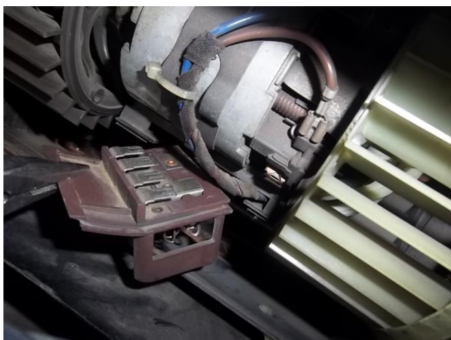
Repérage du bloc résistance défectueux
