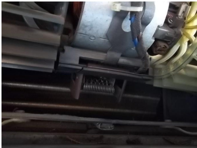
Repérage du bloc résistance défectueux
