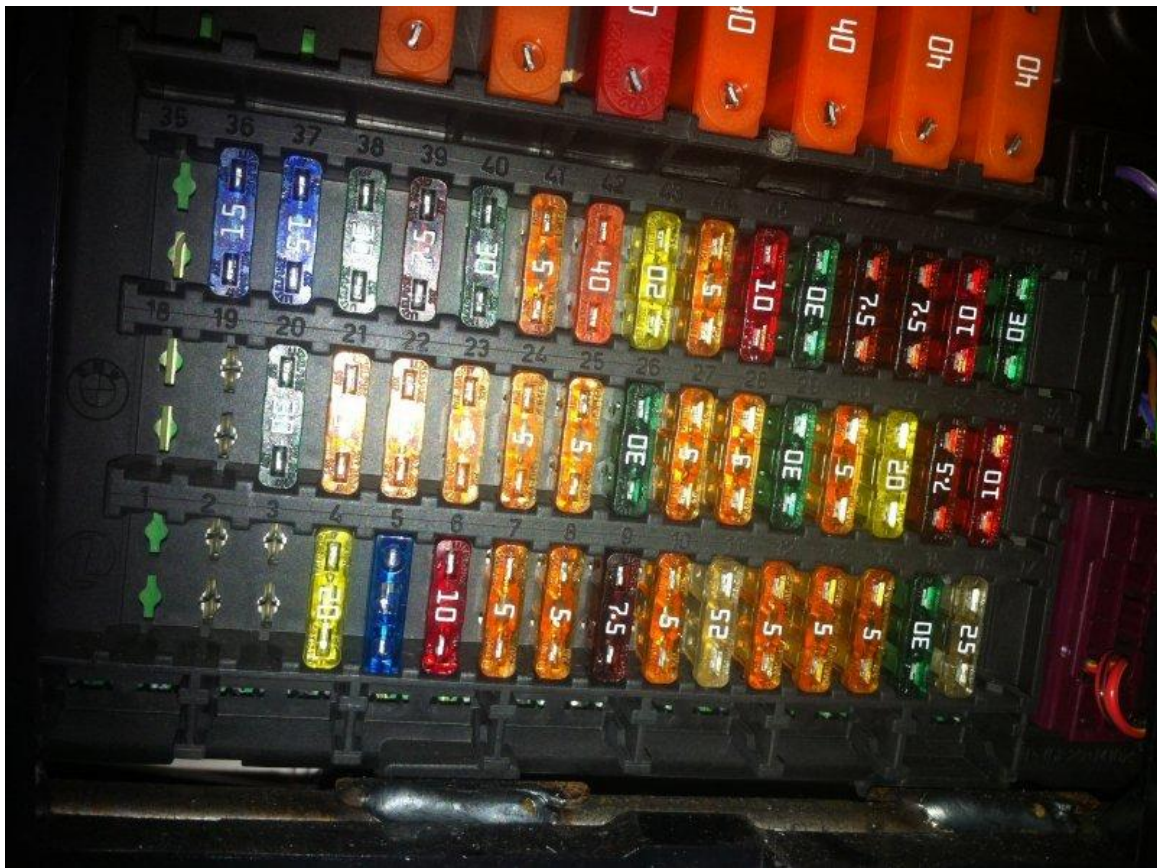
Figure 2: Photos de la platine fusible habitacle A41
