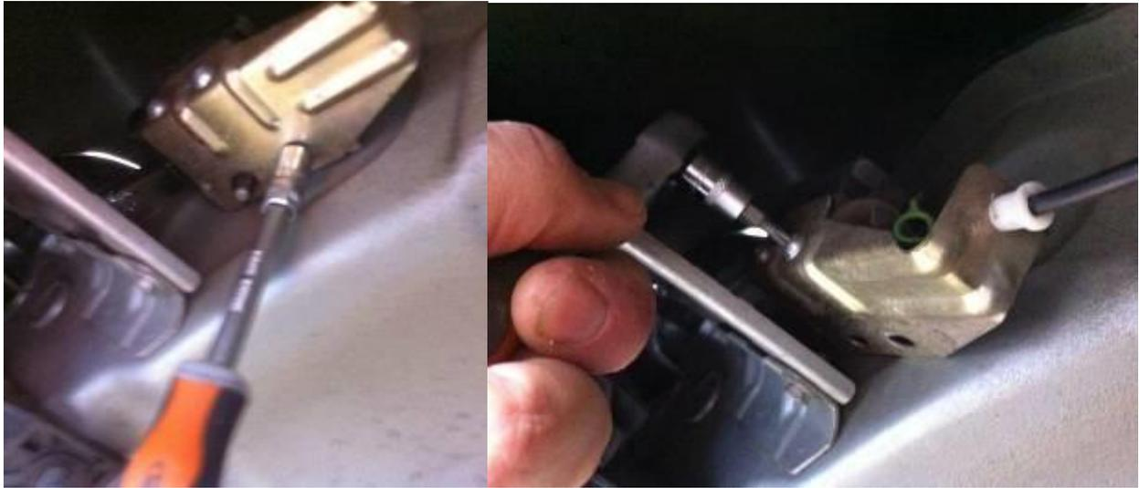
On accède alors au mécanisme et au circlip qu'il suffit de pousser avec un petit tournevis plat (pas besoin de pince à circlip), il vient facilement. On remarque sur la photo la présence d'un petit **mécanisme de retenue en vert**, il faudra penser à le repositionner sur le nouveau câble. Il s'agit du système de déverrouillage de secours accessible depuis l'intérieur du coffre :
