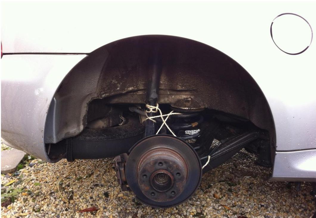
On accède alors à la pièce à changer qui part de l'arrière de l'aile près du feu et qui va jusqu'à la trappe à essence, le câble passant en dessus du passage de roue. **Coté trappe**, il suffit de déclipser le support de câble blanc en tirant dessus :
