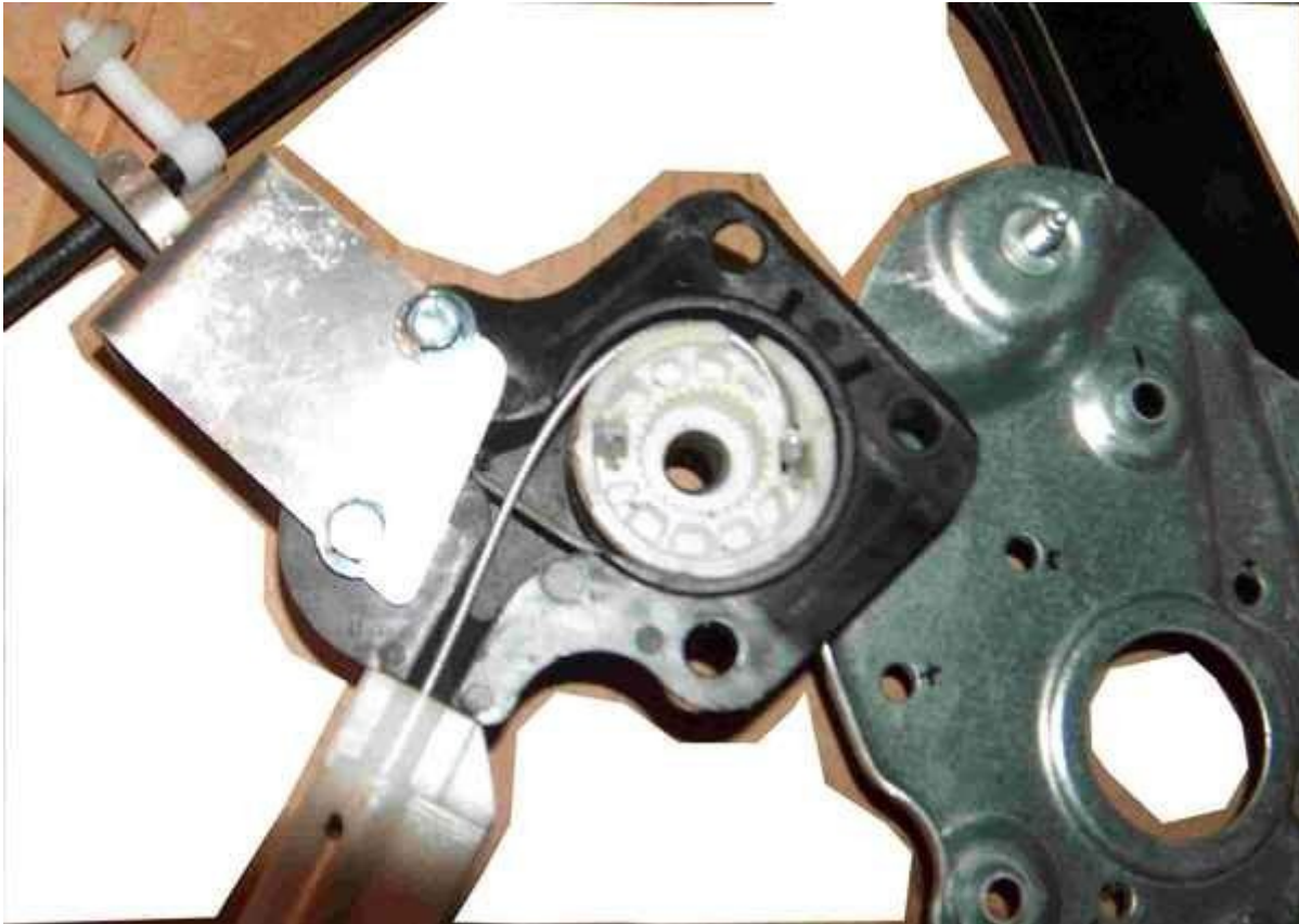
Photo 9: Lève vitre complet réparé, vue intérieure
